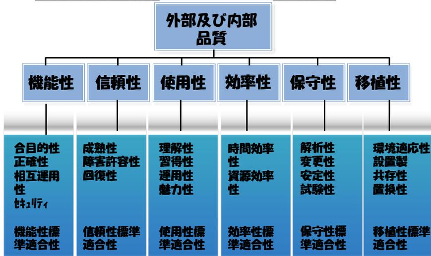
図1.1.1 外部及び内部品質のための品質モデル
