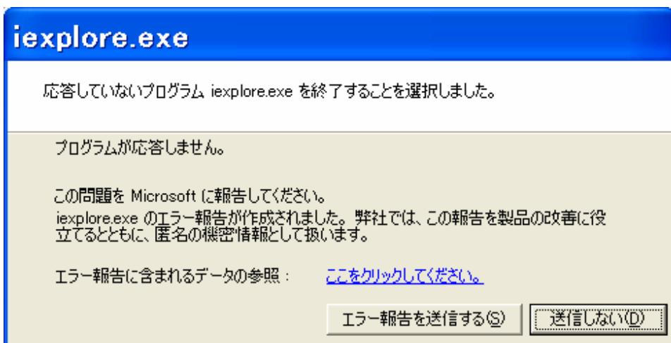
この「プログラムが応答しません」の欠陥は、インターネットを利用している時、月に 1 回の割合で発生しました。システムもダウンしてしまいました。しかしながら、集中的に 50 回実行しても再現しませんでした。
