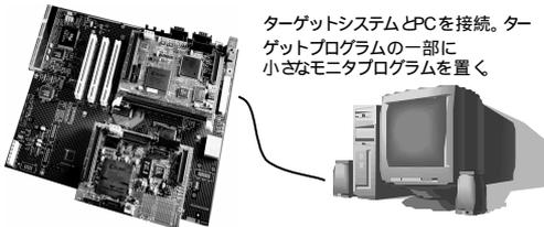
ターゲットシステムとPCを接続。ターゲットプログラムの一部に小さなモニタプログラムを置く。
